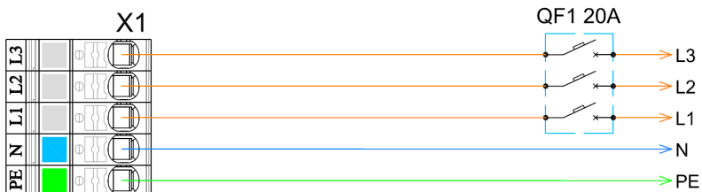
Рис. 5 Схема подключения электропитания 3 фазы 380-400 В/ 50 Гц. Мощность нагревателя 12 кВт
